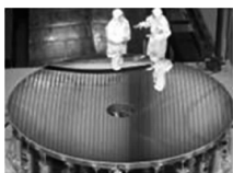
A. 4.03 米大口径碳化硅反射镜
