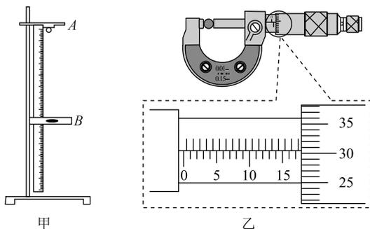
(1)用螺旋测微器测得的小球的直径如图乙所示,则小球的直径  $d =$ \_\_\_\_\_mm.
